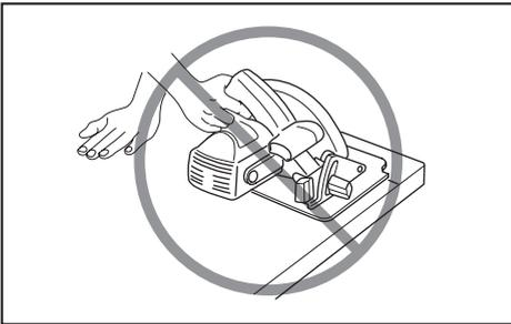
17. **Nunca fuerce la sierra. Empuje la sierra hacia adelante a una velocidad a la que el disco corte sin desacelerarse.** Forzar la sierra durante el corte puede producir cortes desiguales, perder precisión y posiblemente generar un retroceso brusco.
