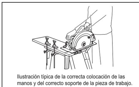
5. **Sujete la herramienta eléctrica por las superficies de sujeción aisladas solamente al realizar una operación en la que la pieza cortadora pueda entrar en contacto con cables ocultos.** El contacto con un cable con corriente también electrificará las piezas metálicas expuestas de la herramienta eléctrica y el operario puede recibir una descarga.
