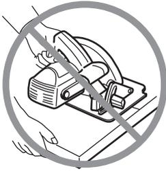
28. Antes de depositar la herramienta tras realizar un corte, asegúrese de que el protector inferior esté cerrado y de que el disco se haya detenido por completo.
