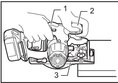
► 1. Empuñadura trasera 2. Empuñadura delantera
